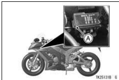
A. Fuse Box
